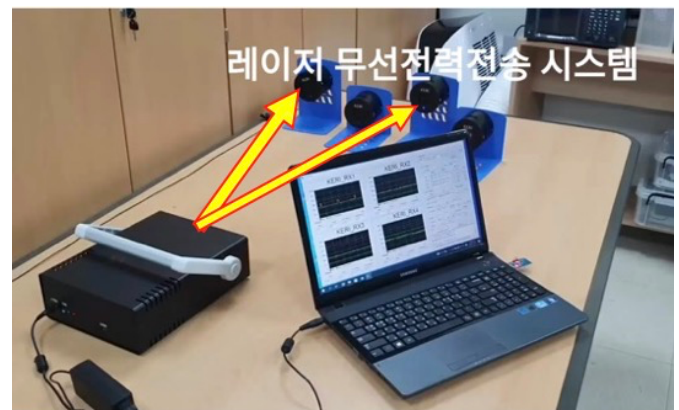
그림 3. 레이저 기반 광파 무선전력전송 IoT 센서네트워크 통신 시스템 구현 사진 (구성: 광전송 송신기, 4대의 AE센서 임베딩 IoT 센서 수신기 및 시스템 관리, 전력 상태모니터링과 데이터 분석용 PC노트북)
